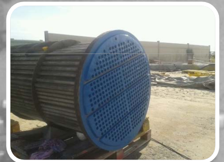
4. Protección final con METALCLAD CeramAlloy CL+(AC)
