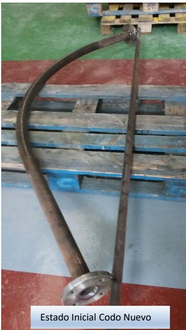
Por este motivo, se contactó con PROENECON para buscar un sistema que permita alargar la vida útil de los codos y minimizar el número de paradas de la Línea. Se especificaron y aplicaron 10 mm de espesor de METACLAD CeramAlloy CBX en el arco exterior que sufre los problemas de abrasión extrema tras una preparación inicial de la superficie mediante chorro abrasivo y tras imprimir la superficie con una capa de METALCLAD CeramAlloy CL+(AC) azul.
