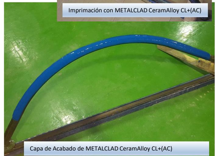
**Tras la realización del tratamiento anterior, el codo dispone de un blindaje externo de altísima resistencia a la abrasión, que proporcionará una vida adicional a éste una vez se perfore todo el espesor de la tubería**
