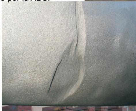
Primeramente se realizaron diversos chorreados para eliminar todas las capas de óxido y para conseguir llegar a un grado de limpieza de metal blanco y un perfil de anclaje adecuado.
