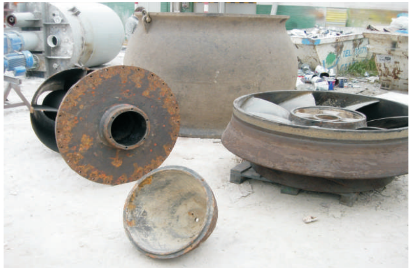
LOS DISTINTOS COMPONENTES ANTES DE SU REPARACIÓN
